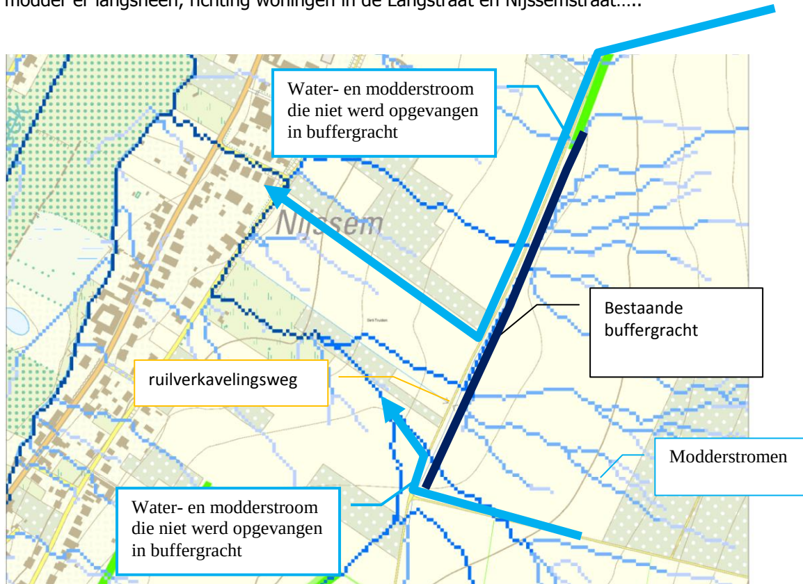
Figuur 2 : belangrijkste aanvoerroutes van water en modder naar Lijsemstraat en Langstraat
